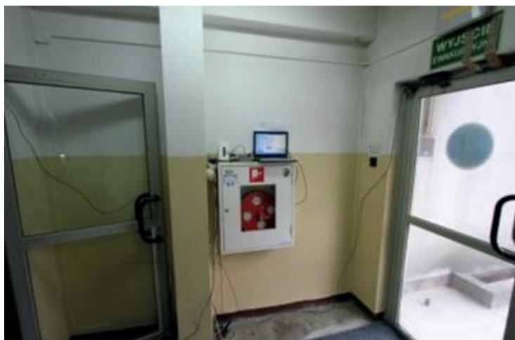
Rycina 3. Aparatura pomiarowa składająca się z czujnika zamontowanego w górnej części ramy drzwi połączonego wraz z jednostką liczącą do komputera z odpowiednim oprogramowaniem [2, 3]
