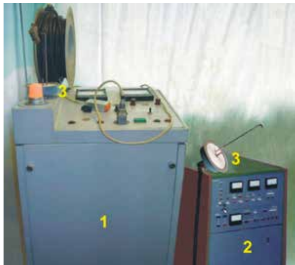
Рис. 11. Общий вид «Устройства» для создания электрического теплового взрыва: 1 – базовый блок управления и первого канала, 2 – дополнительный 2-й блок, 3 – энерговыделяющие узлы 1-го и 2-го каналов
