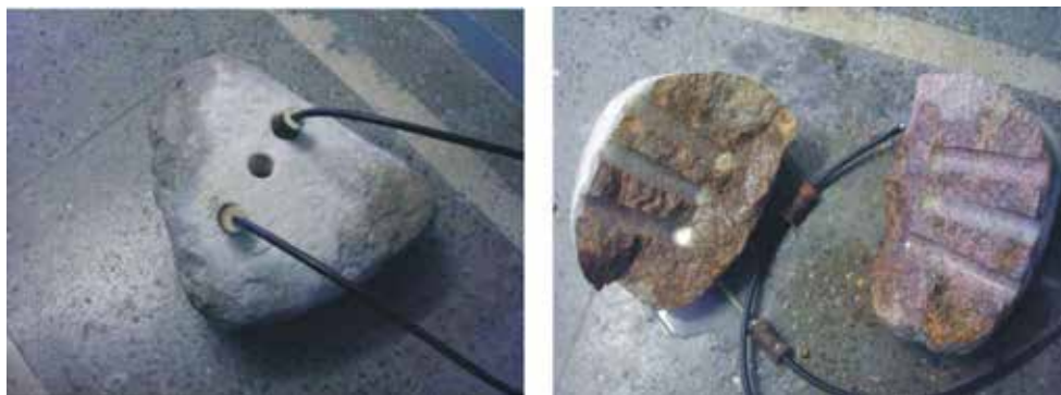
Рис. 13. Разрушение объекта из гранита по заданной линии раскола при двухканальном воздействии Fig. 13. Destruction of granite on a given line of a split in the two-channel impact
